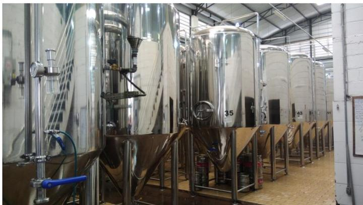
Figura 4 – Tanques Fermentadores
