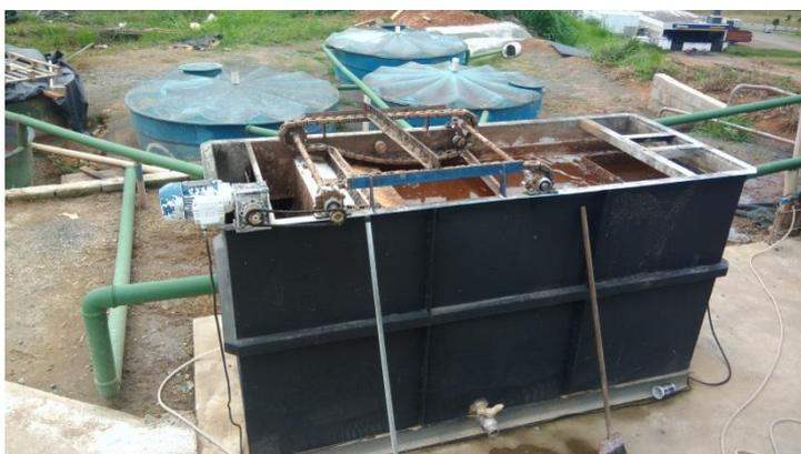
Figura 8 – Flotador
