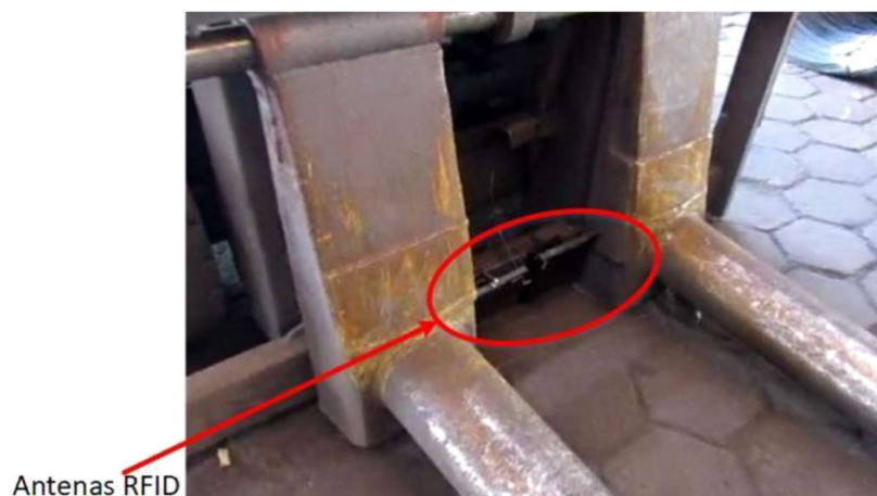
Figura 5 - Antenas na empilhadeira para a leitura da identificação dos rolos
