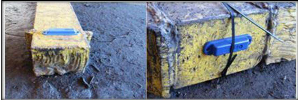
Figura 8 - Tag RFID de posicionamento das baias
