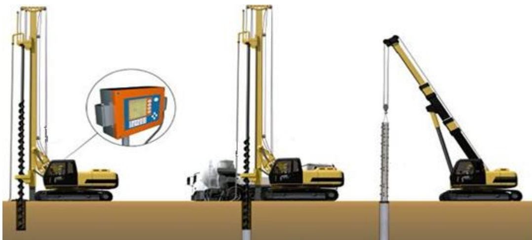
Figura 13 - Hélice Continua monitorada.
