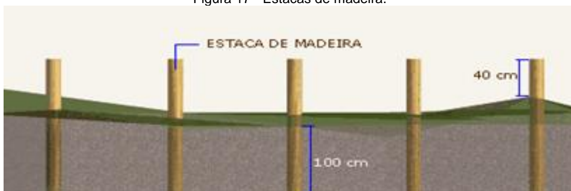
Figura 17 - Estacas de madeira.
