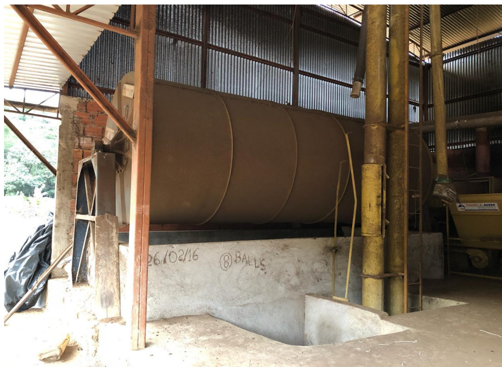
Figura 1: Secador rotativo utilizado na propriedade em São Domingos das Dores.
