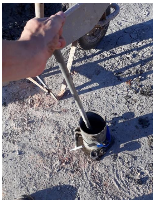
Figura 3.5: Adensamento do concreto nos moldes.
