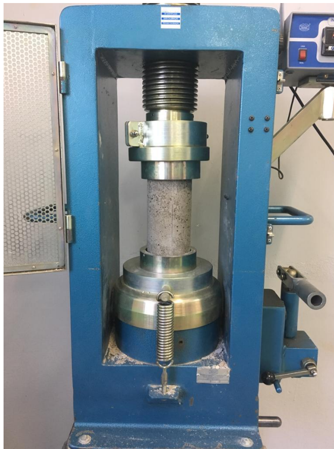
Figura 3.8: Rompimento de corpo de prova por meio de prensa hidráulica.
