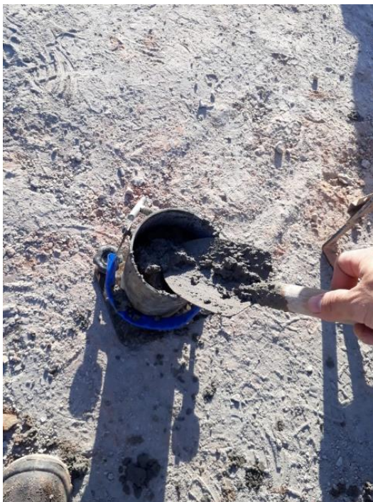
Figura 3.4: Colocação do concreto nos moldes.
