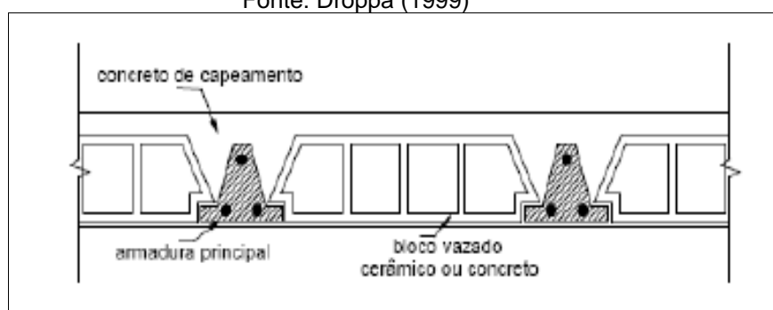
Figura 2.4: Vigota de concreto armado comum (VC)
