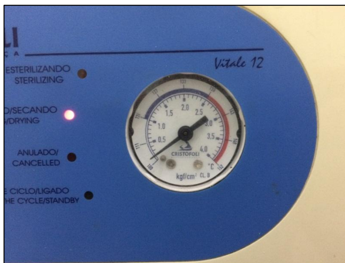
Figura 15 - Manômetro de Pressão
