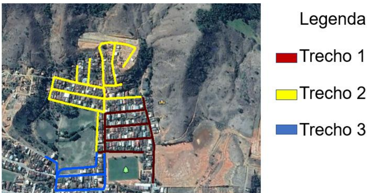
Figura 11 – Delimitação dos trechos com contribuição de esgoto
