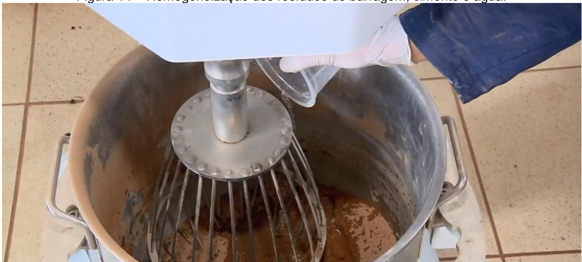
Figura 14 – Homogeneização dos resíduos de barragem, cimento e água.
