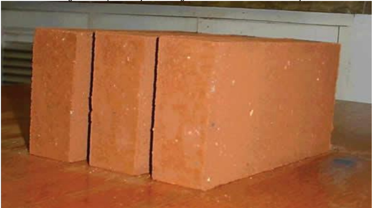
Figura 6 – Tipos de Tijolos Ecológicos Com Resíduos de Construção
