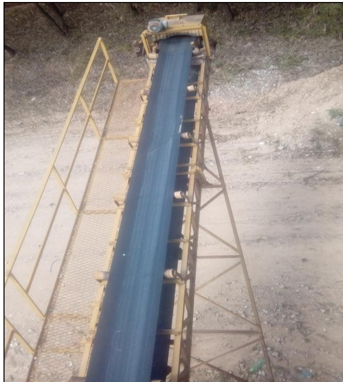
Figura 16– Transportador de correias no processo de reciclagem dos RCCDs.
