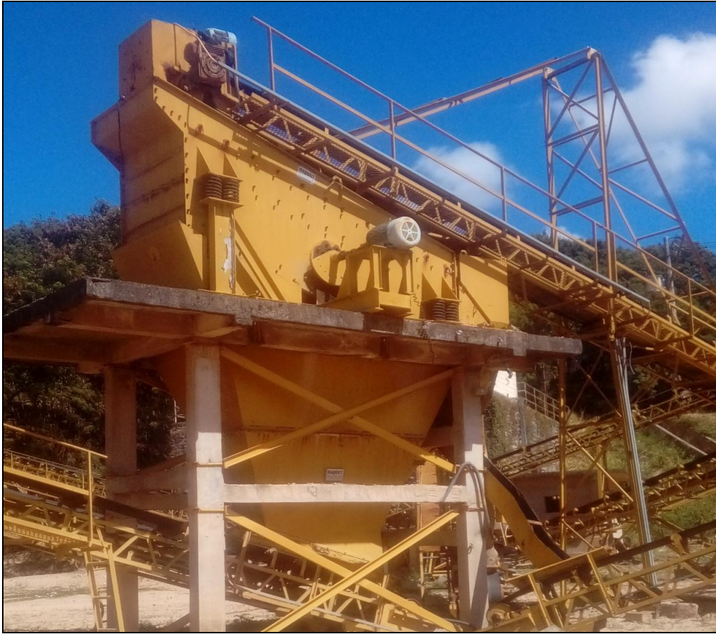
Figura 15 – Peneira vibratória no processo de classificação dos RCCDs.
