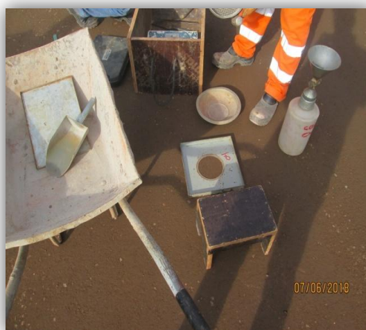
Figura 29- Ferramentas Utilizadas para Ensaio de Grau de Compactação
