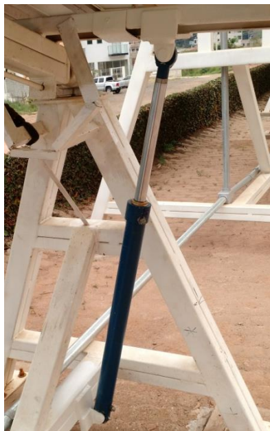
Figura 30 - Cilindro hidráulico montado com articulação rotulada da haste
