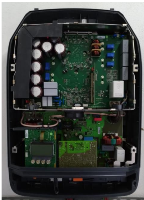
Figura 33 - Imagem interna do Inversor fotovoltaico no momento da reconfiguração
