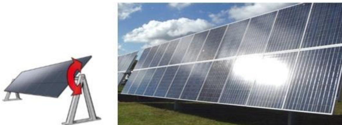
Figura 18 - Rastreador solar do tipo roll-tilt – Seguidor de Eixo Horizontal
