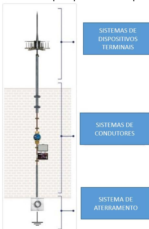
Figura 4 – Principais partes de um para raio
