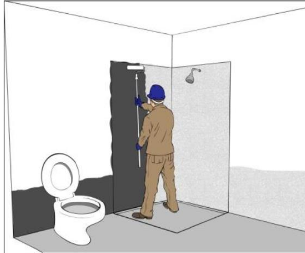
Figura 13 - Esquema ilustrativo de impermeabilização vertical em banheiros
