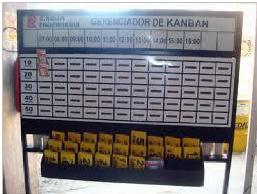
Figura 5: Gerenciador de Kanban de argamassa
