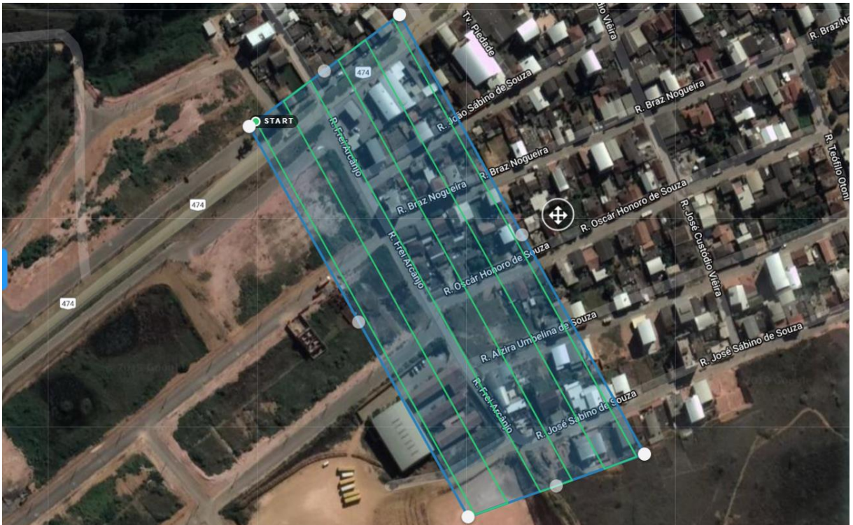
Figura 12 detalhamento das linhas do plano de voo da área de estudo (FONTE O AUTOR 2019)
