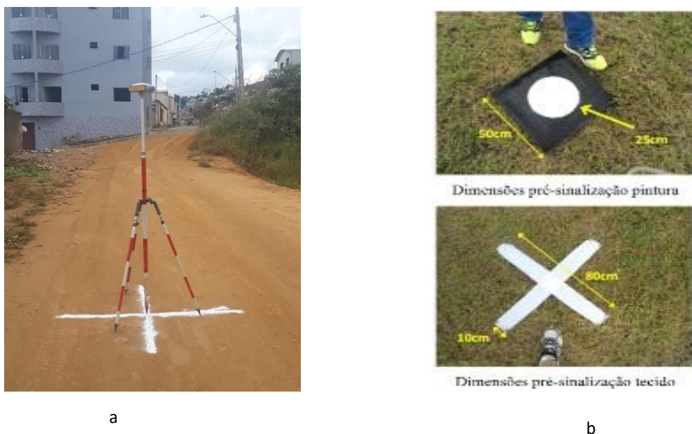
Figura 16 – Coleta dos pontos de controle (a) pré-sinalização em campo marcos de apoio e checagem e dimensões dos marcos de apoio e checagem (b)
