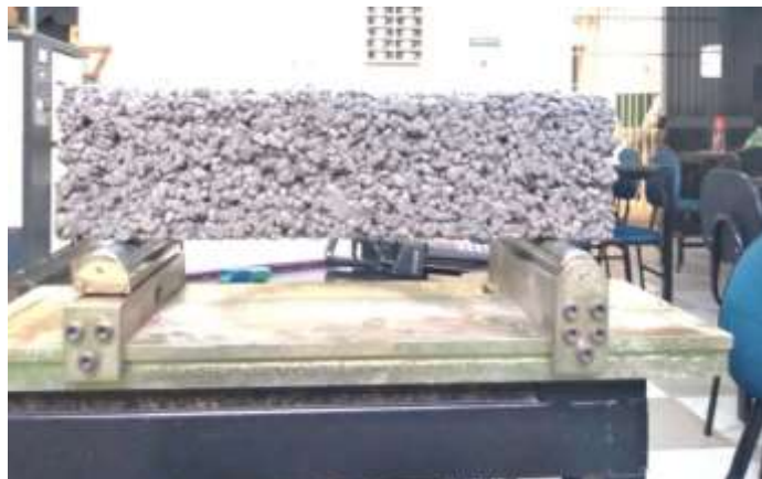
Figura 19: Bloco prismático no aparelho
