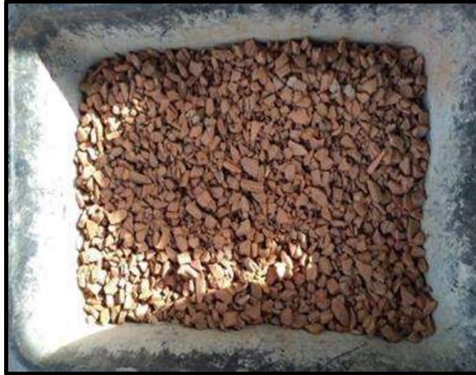
Figura 8: material cerâmico de resíduos da construção (RCC)
