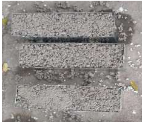
Figura 13: Concreto adicionado aos moldes prismáticos
