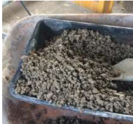
Figura 11: Concreto permeável com agregados mistos (Brita zero e material reciclado) após o preparo na betoneira
