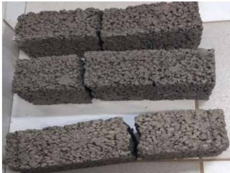
Figura 21: Blocos rompidos após o teste resistência de tração na flexão com brita 0
