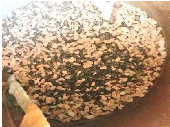
Figura 10: 75% de Brita Zero e 25% de material cerâmico reciclado na betoneira
