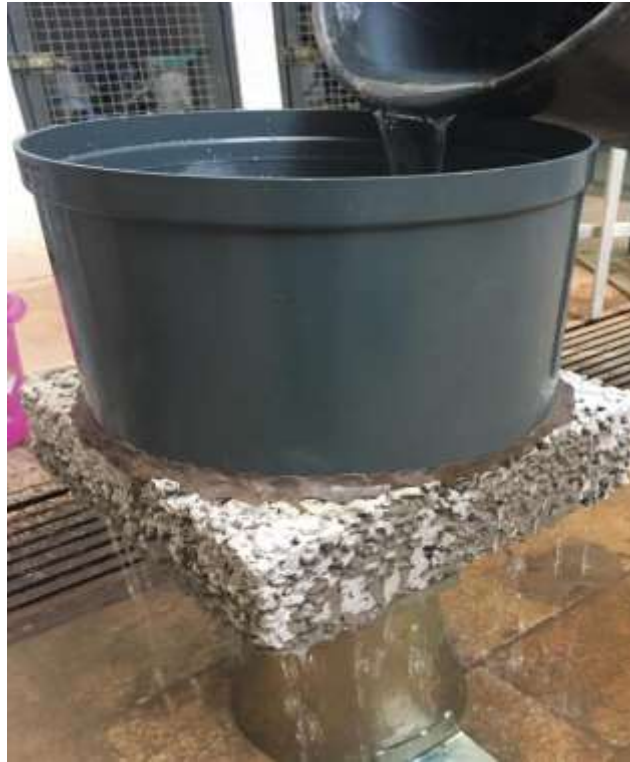
Figura 22: Teste de permeabilidade
