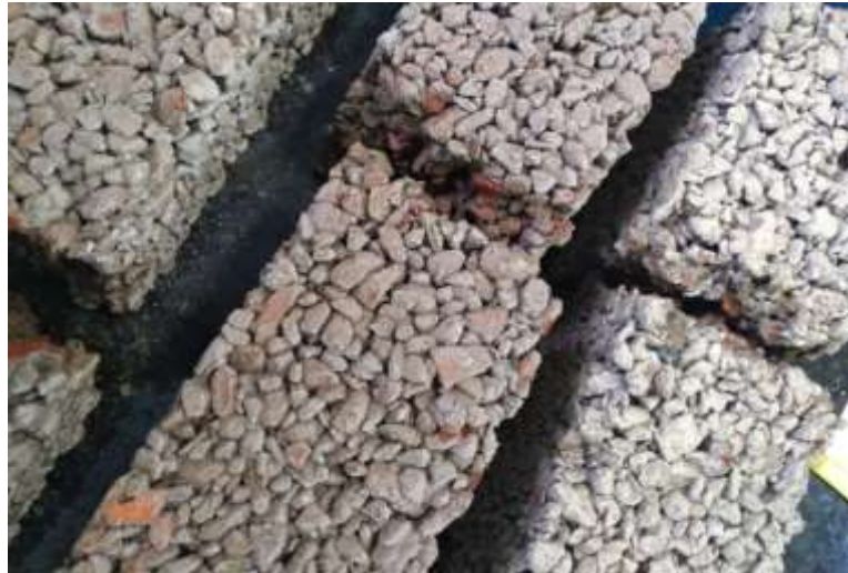
Figura 20: Blocos rompidos após o teste de resistência de tração na flexão com agregado cerâmico (RCC)
