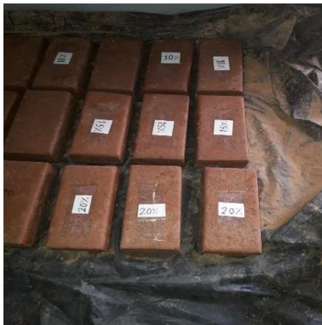
Figura 8 - Tijolos após os 28 dias de cura
