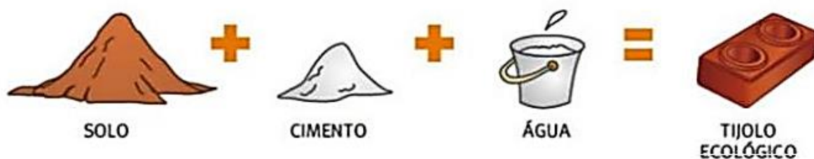
Figura 1 - Composição do tijolo solo-cimento
