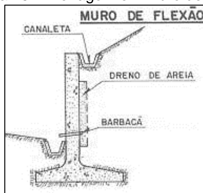
Figura 15 - Drenagem em muro de flexão
