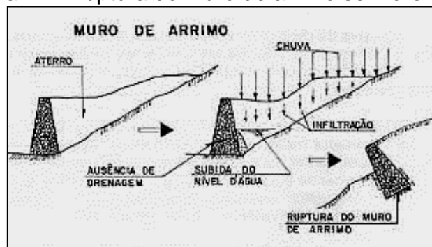
Figura 12– Ruptura do muro de arrimo sem drenagem
