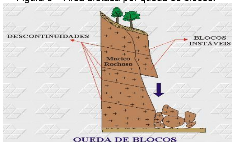
Figura 6 – Área afetada por queda de blocos.
