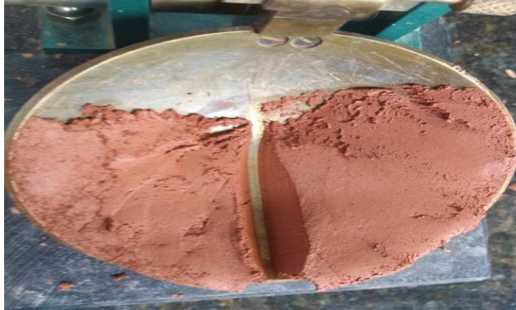
Figura 21 – Ranhura na amostra para determinação de liquidez
