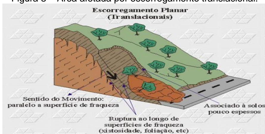
Figura 3 – Área afetada por escorregamento translacional.
