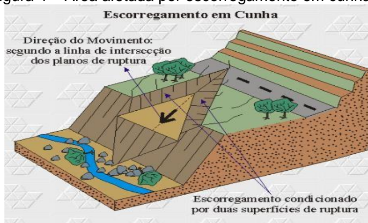
Figura 4 – Área afetada por escorregamento em cunha.
