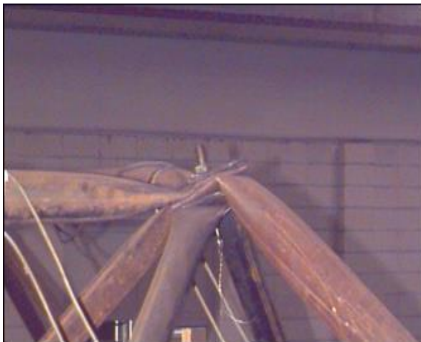
Figura 3 – Plastificação da extremidade da barra
