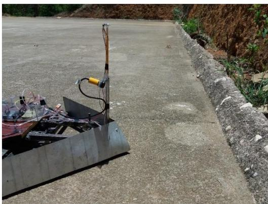
Conforme visto anteriormente o sensor infravermelho, de cor amarela situado acima da ferramenta que vai revolver o café mantém uma distância entre a frente do protótipo e o terreiro, ou seja ele apenas vai ser acionado se essa distância for menor.
