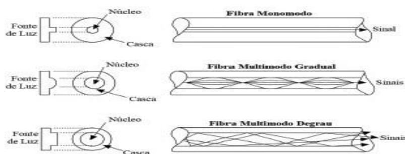
Figura 20 – Propagação da Luz na Fibra Óptica
