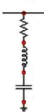
**Figura 3** — Filtro sintonizador RLC.
