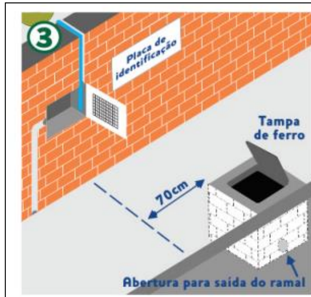
Figura 06: Vista da rua da caixa de esgoto.
