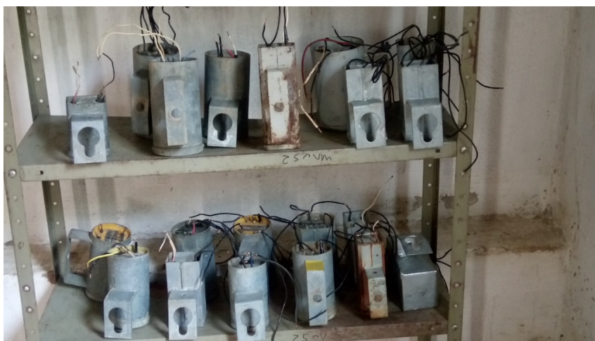
Figura 9: Reatores separados para testes (FONTE: Autor, 2017)
