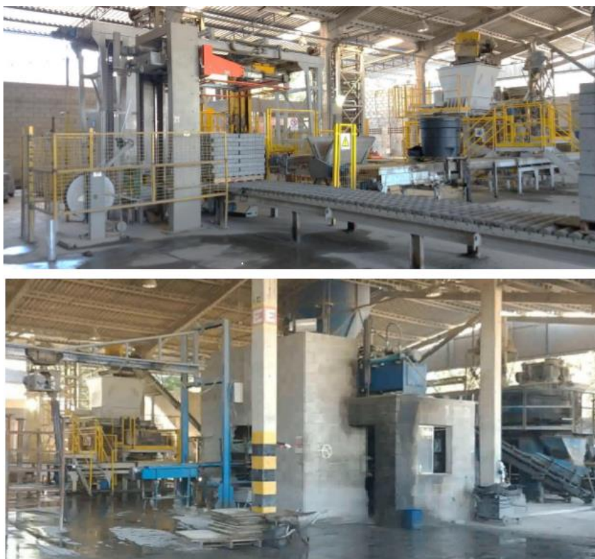
Figura 10: máquina automatizada Poyatos e a P2, máquina mecanizada T-Prex, respectivamente Fonte: autor, 2021.
