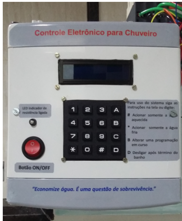
Figura 16: Protótipo Etiquetado com Instruções de Uso
