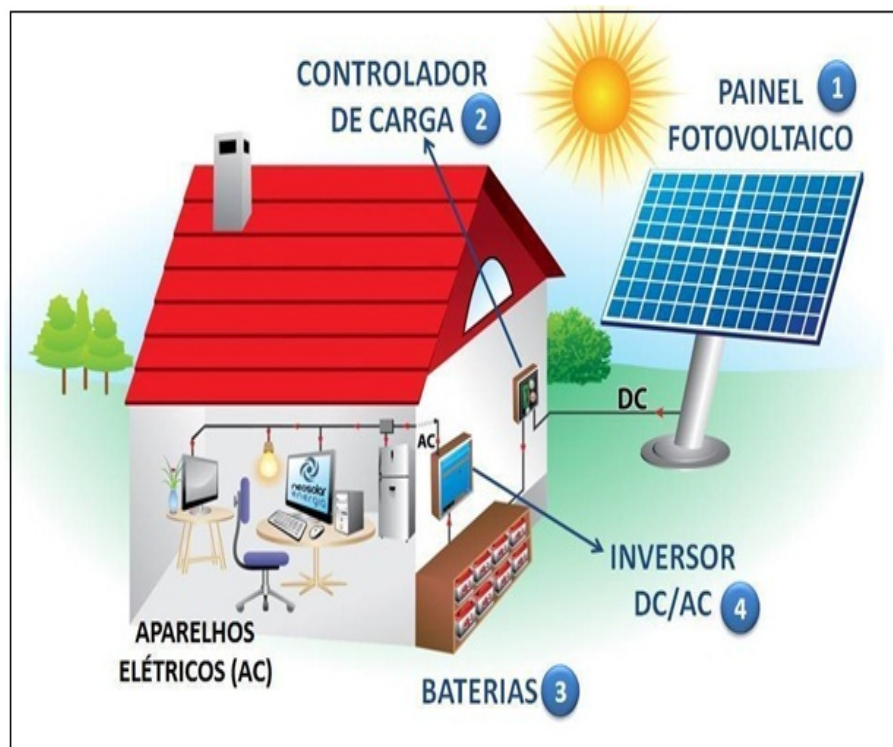
Figura 2: Exemplo de sistema fotovoltaico isolado.
