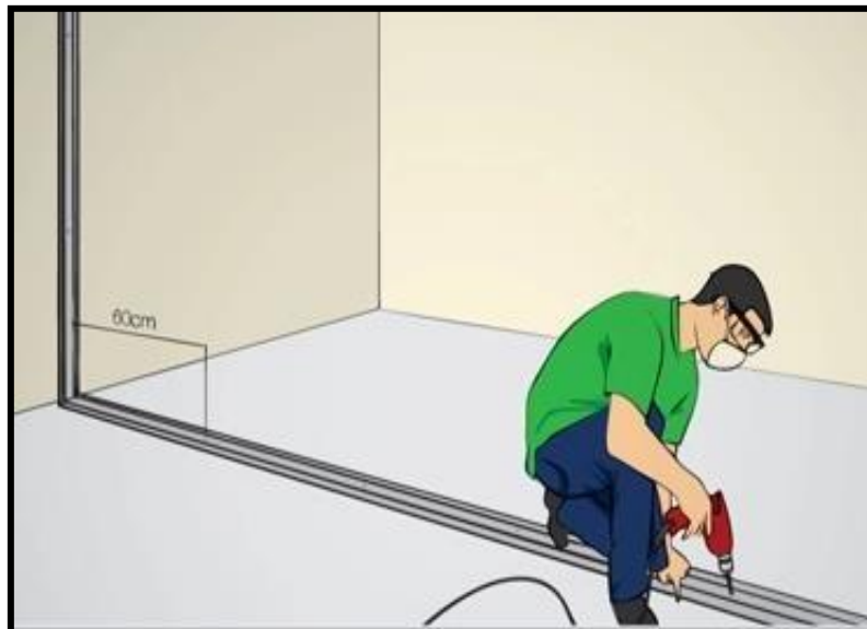
Figura 2 - Marcação e instalação das chapas Zincadas.
