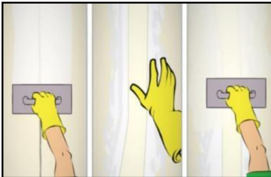
Figura 7- Acabamento da vedação em drywall
