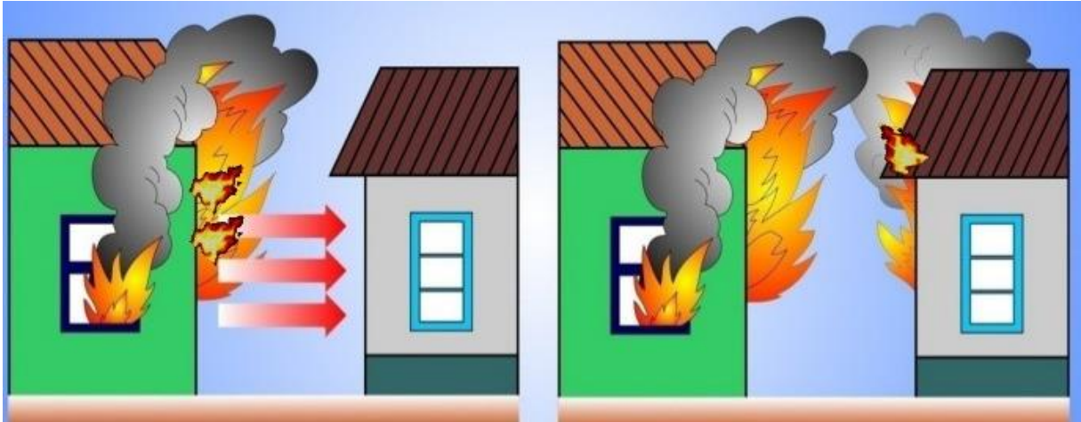
Figura 2. Irradiação de calor (MFCB – CBPMESP, 2006).
