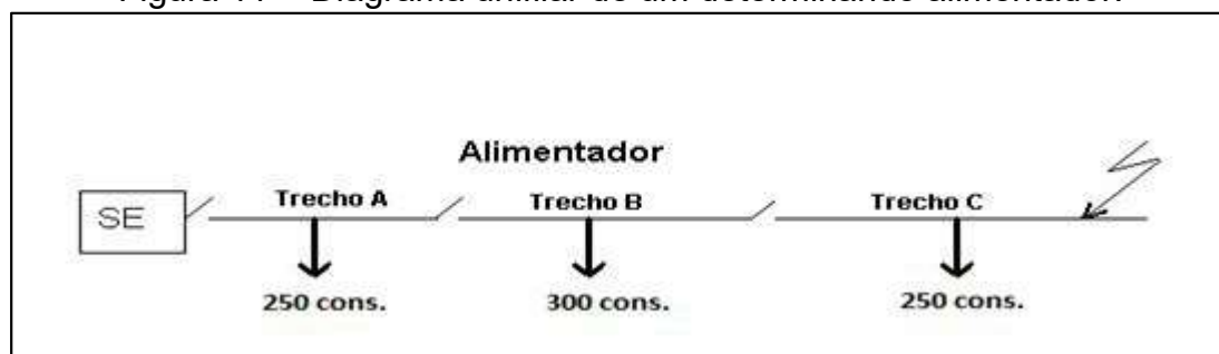
Figura 11 - Diagrama unifilar de um determinado alimentador.
