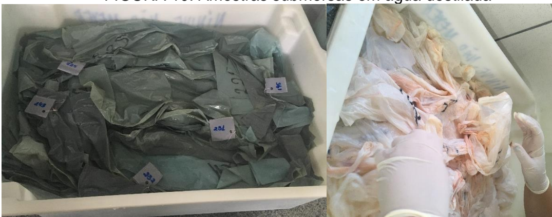
FIGURA 10: Amostras submersas em água destilada
