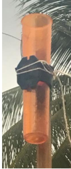
FIGURA 7: Aparelho para a medição pluviométrica
