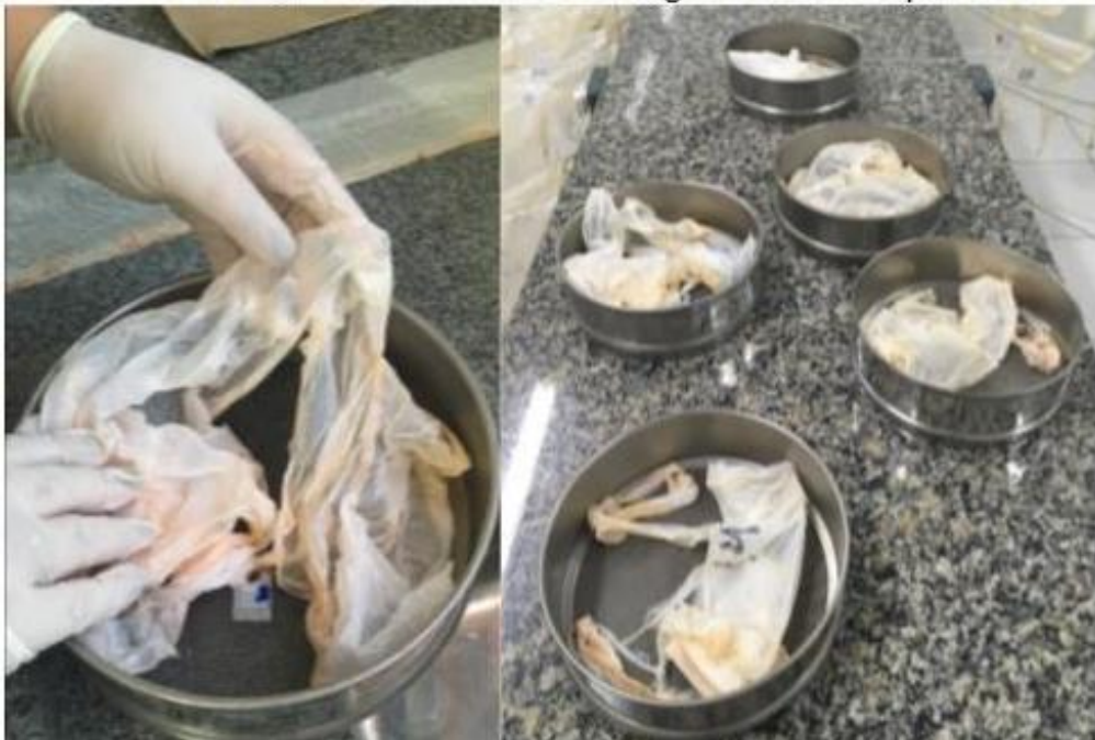
FIGURA 12: Processo de secagem utilizando peneiras
