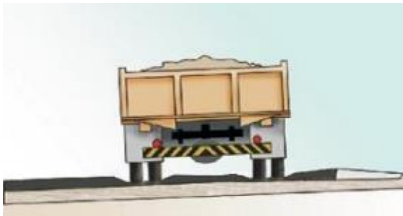
Figura 7: Deformação permanente em pavimentos asfálticos na camada do revestimento
