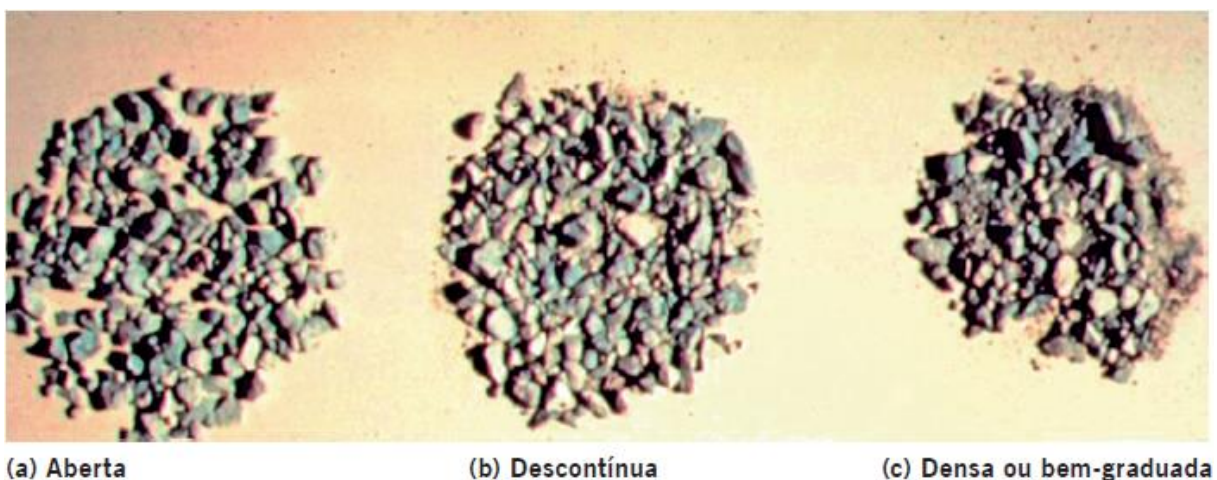
Figura 6: Composições granulométricas dos tipos de mistura a quente
