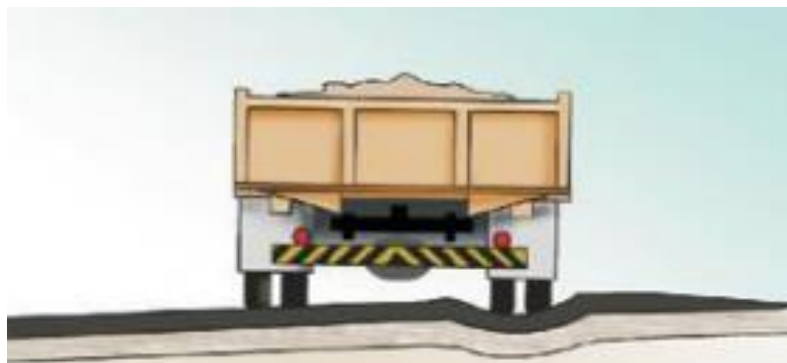
Figura 8: Deformação permanente em pavimentos asfálticos com deformação em mais de uma camada (trilha da roda direita)
