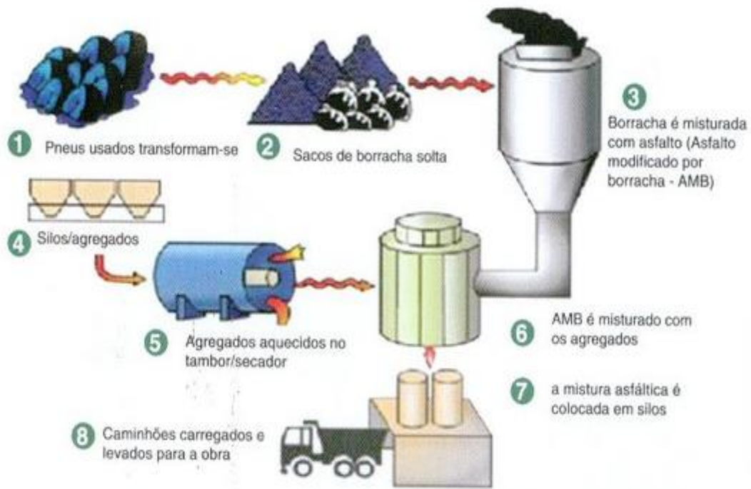
Figura 10: Processo de mistura estocável do asfalto borracha.
