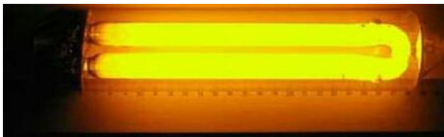
Figura 13 - Lâmpada a vapor de sódio de baixa pressão em pleno funcionamento
