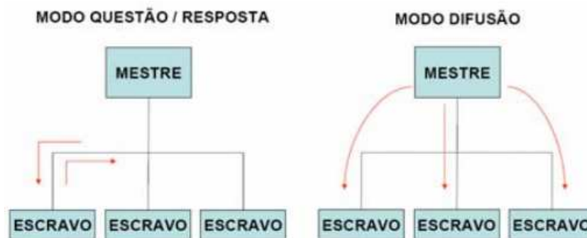
Figura 8 – Protocolo Modbus (Modo de Comunicação: Mestre/Escravo)
