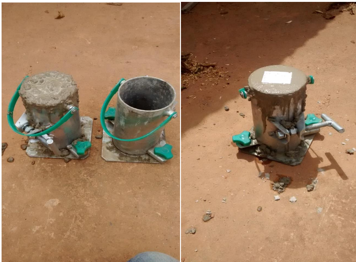
Figura 13: Adensamento da segunda camada e identificação do corpo de prova
