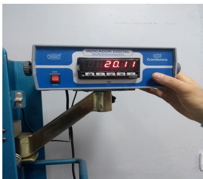
Figura 18: Identificação do valor de carga pelo amostrador digital
