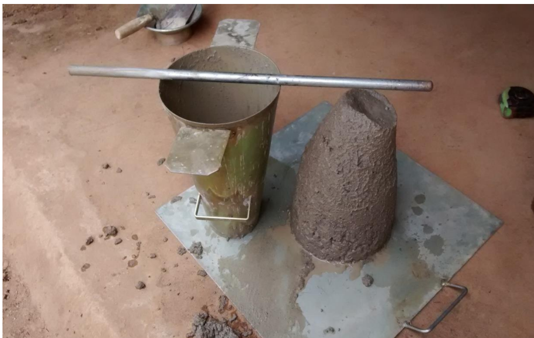
Figura 19: Medição do abatimento do concreto
