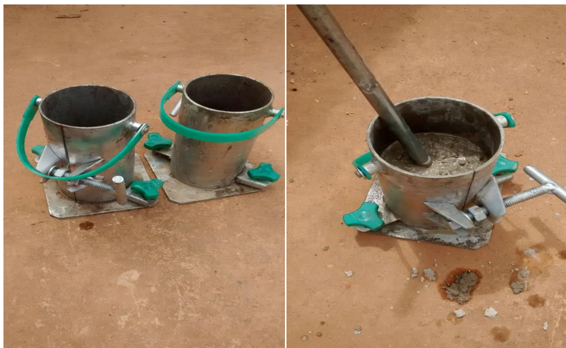
Figura 12: Moldes para CPs e Adensamento primeira camada
