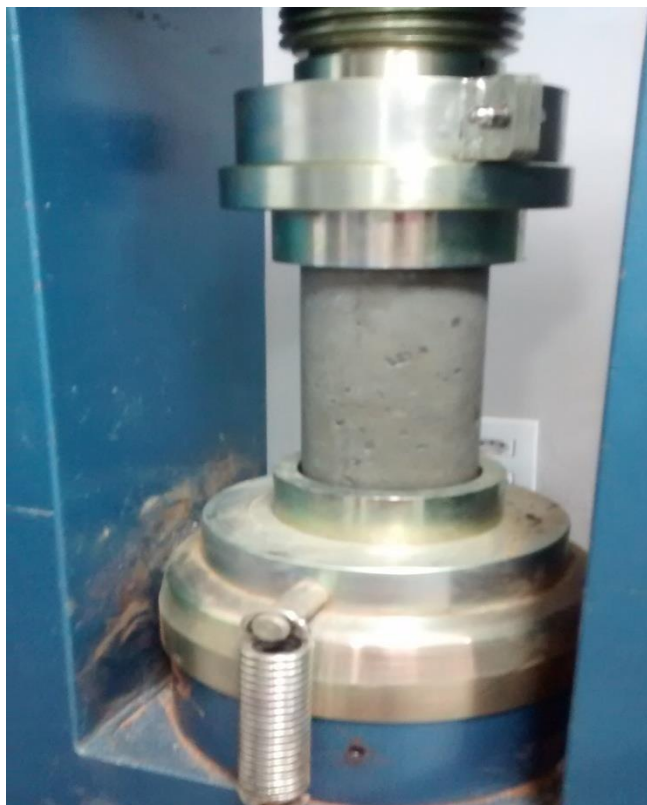
Figura 15: CP centralizado na prensa
