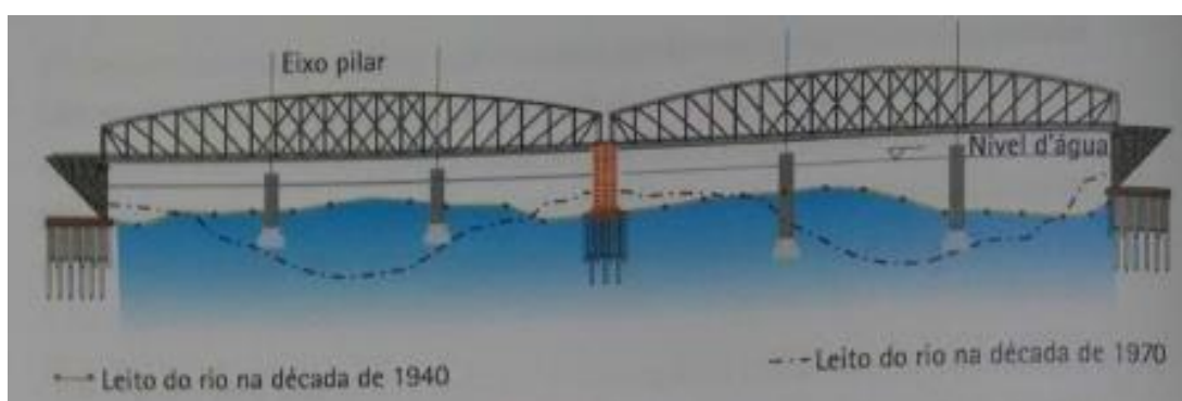
Figura 35 Evolução do leito do rio ao longo de trinta anos, mostrando o solapamento ocorrido
