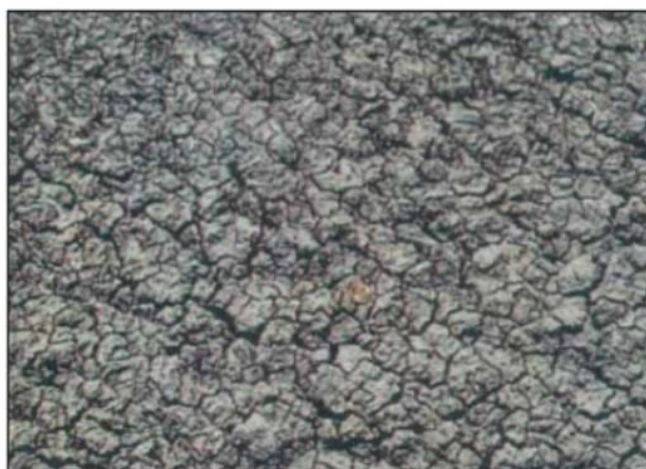
Figura 28 Aspecto do empastilhamento em sedimentos constituídos por argilo-minerais do grupo das esmectitas
