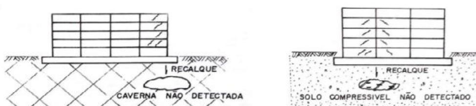
Figura 21 Deficiência na investigação geotécnica.
