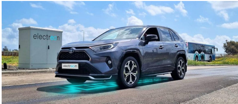
Figura 6: Carregamento de carro elétrico por indução eletromagnética
