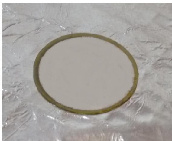
**Figura 17:** Pastilha piezoelétrica sem as bordas de latão pzt-4.
