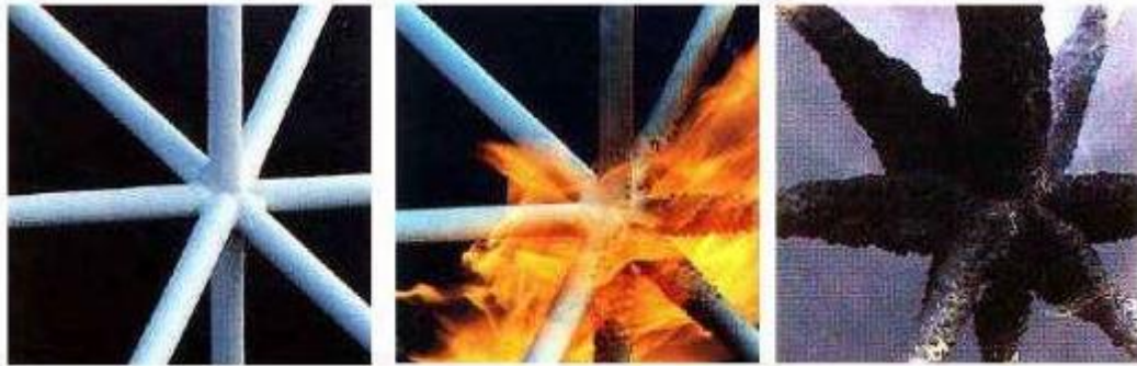
Figura 4 – Tinta intumescente exposta ao fogo
