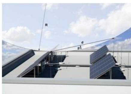
Figura 20: Painéis solares dentro da zona de proteção de um SPDA.
