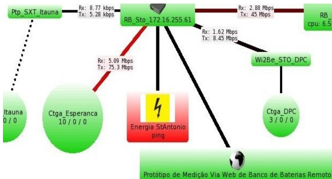
Figura 25: Monitor de energia em destaque de vermelho após o desligamento da energia elétrica
