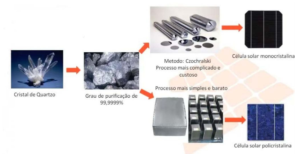
Figura 4 – Diferença na fabricação das células monocristalinas e policristalinas.
