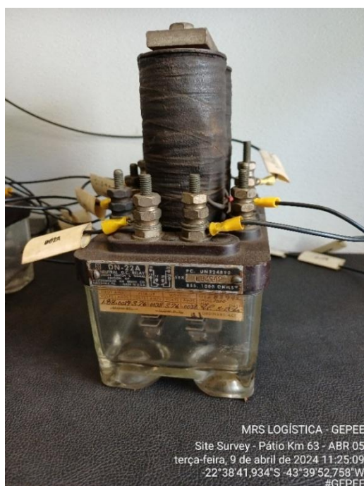
Figura 5 - Relés de bancada [relay shelf] Fonte: fotografado pelo autor 2024
