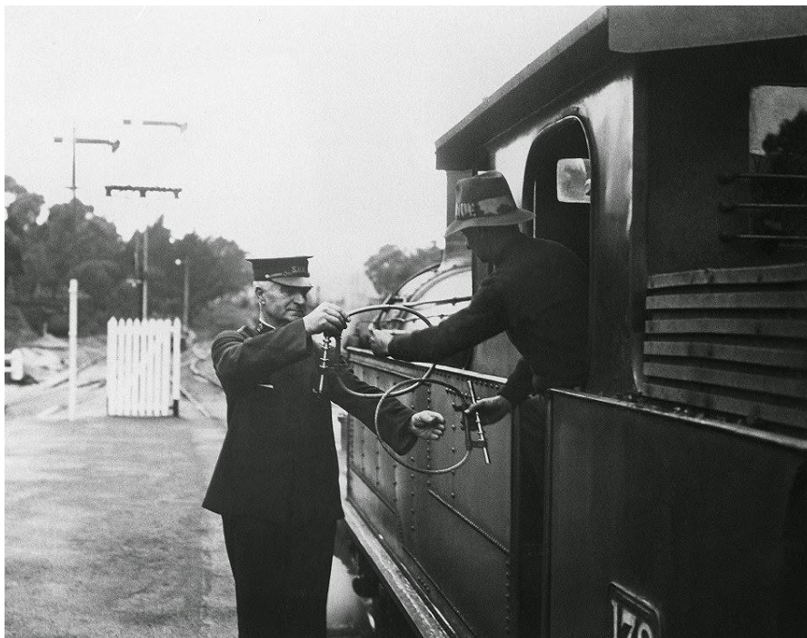
Figura 3 - Troca de bastões na ferrovia South Australian Railways em 1960. Fonte: http://www.johnnyspages.com/jamestown.htm
