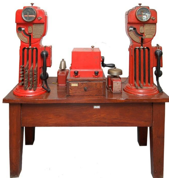
Figura 2 - Máquina de staff ferroviária utilizada no controle de circulação em linhas simples Fonte: MIGUEL SALLES. Máquina de staff ferroviária. Disponível em: https://www.miguelsalles.com.br/peca/35506/maquina-de-staff-ferroviaria . Acesso em: jun. 2025.
