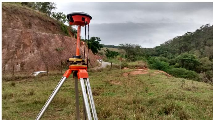
**Figura 20:** Levantamento realizado por GPS RTK NAVECOM.
