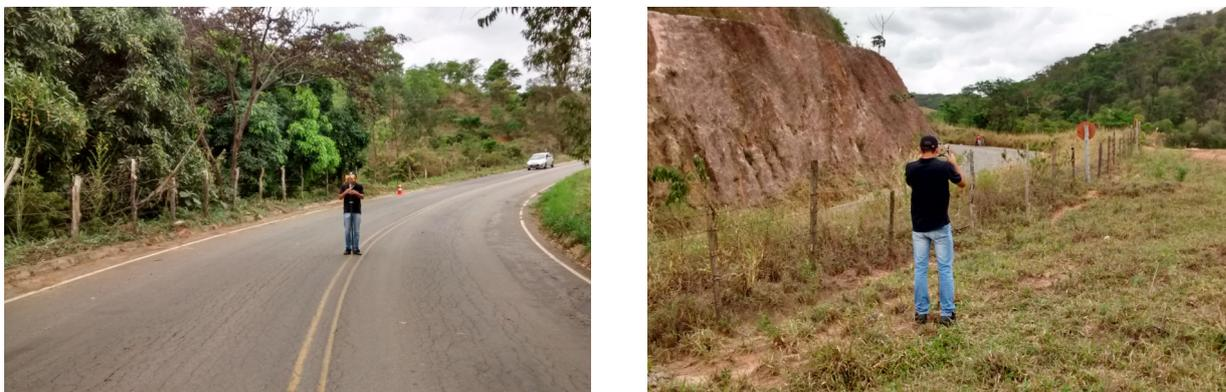
**Figura 19:** Levantamento curva 1 realizado por Estação Total.
