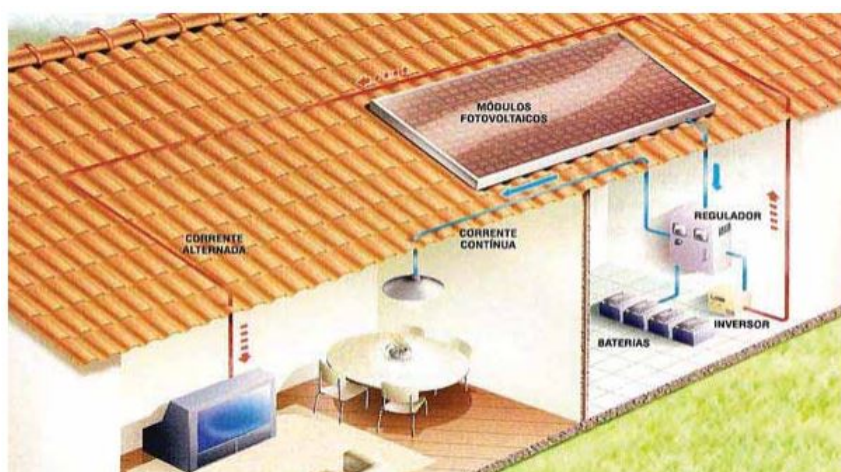
Figura 3: Sistema de Energia Solar Fotovoltaica.
