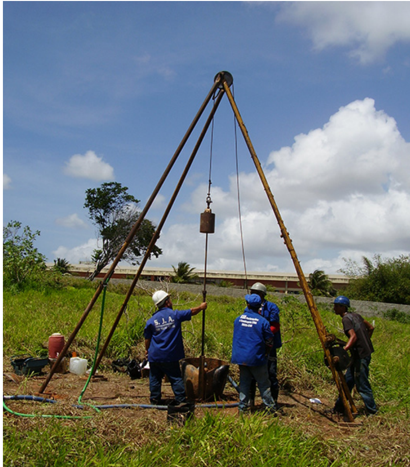
Figura 1: Realização de ensaio à percussão.
