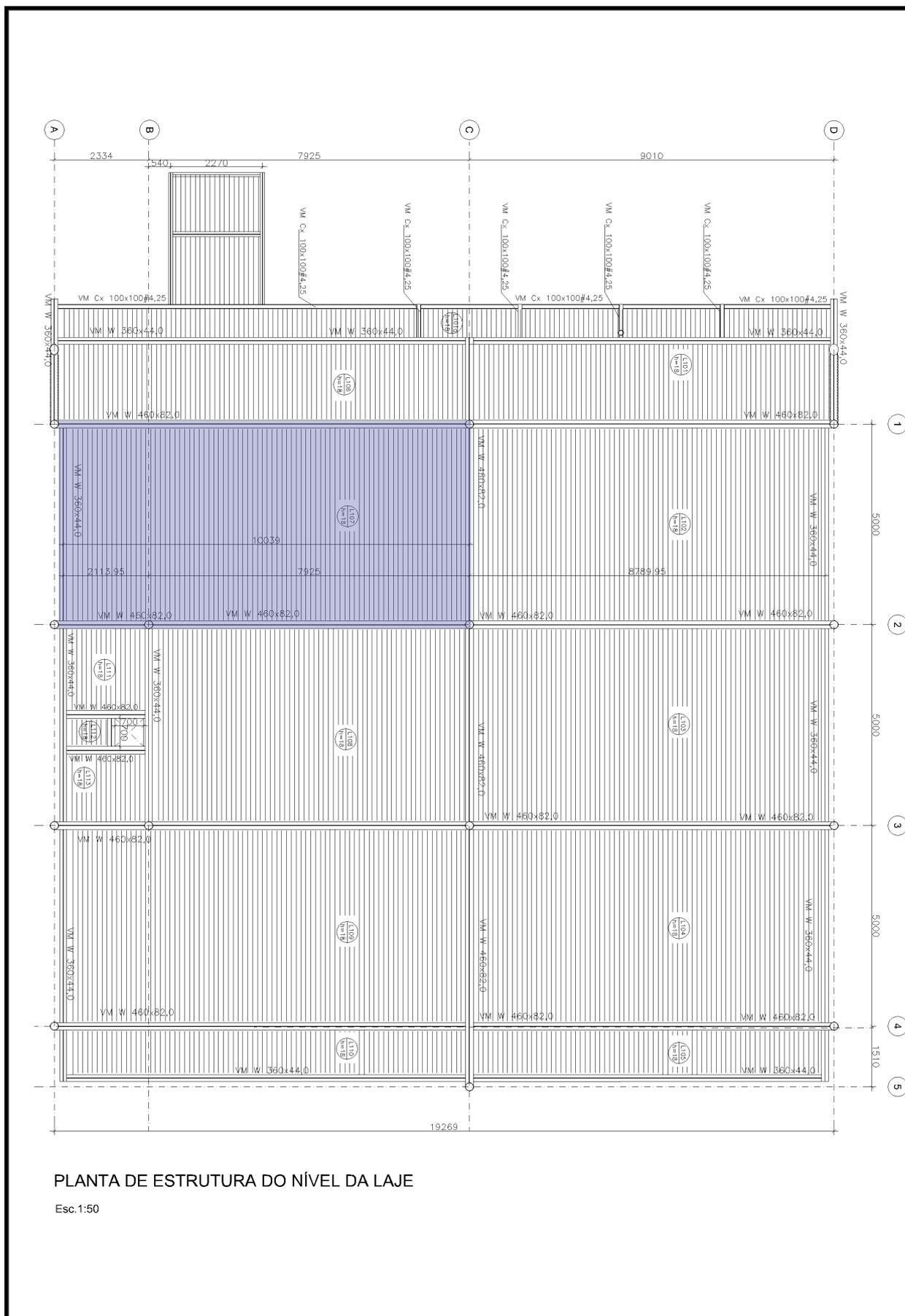
Figura 10: Planta estrutural da laje PTM (Cortesia de Prof. ROCHA, 2016).
