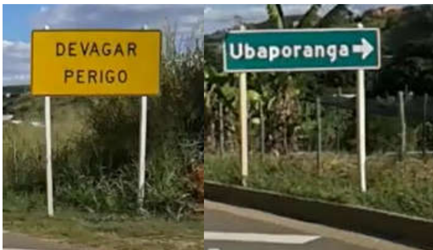
Figura 41 – Placas de sinalização de advertência e indicação
